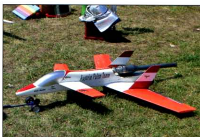
Model Delfino kachní koncepce Rakušana Aloise Martina poháněný pulzačním motorem
